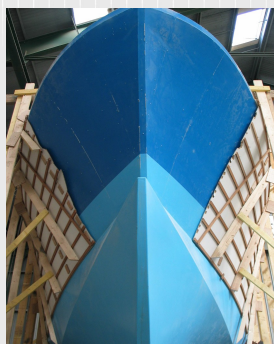
Démoulage de la coque
